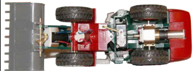
Getriebebausatz G494B, in einem 1zu87 Radlager eingebaut
